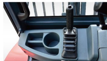
棘轮式手制动 运动可靠,操作力小。
